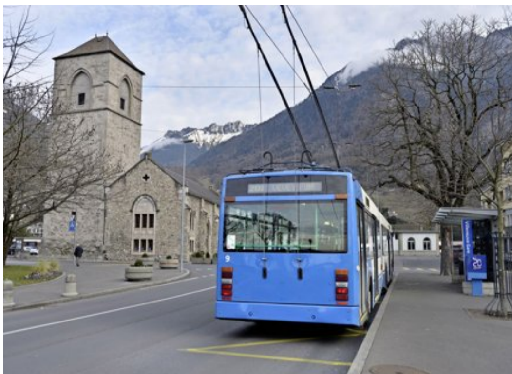
La ligne aérienne subsistera entre Vevey et Villeneuve. Mais au-delà, les trolleybus circuleront grâce à leur batterie. C.DERVEY
